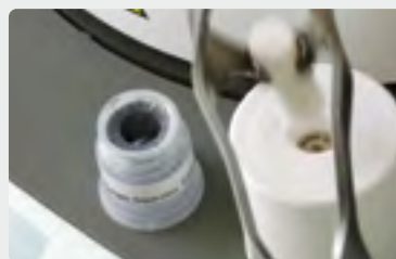
Anschließend den mit Pulver benetzten IPS Alox-Kolben in die heisse Muffel geben.
