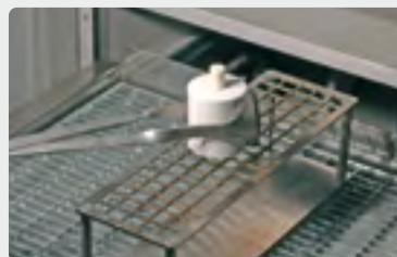
Nach Beendigung des Pressprogramms die heisse Muffel mit der Muffelzange auf das Abkühlgitter stellen und zugluftfrei auf Raumtemperatur abkühlen lassen.
