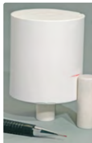
Länge des Alox-Kolbens markieren.
